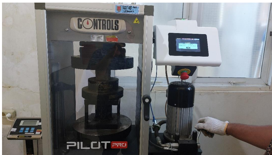
Gambar 4.6 Pengujian Kuat Tekan Paving Block
