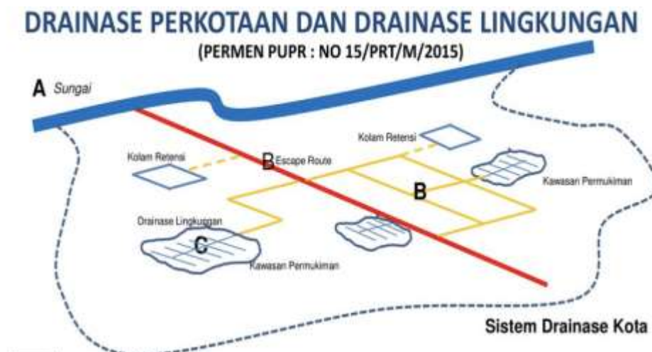
Gambar 2.2 Penanganan Sistem Drainase (Sumber : PERMEN PUPR, 2015)
