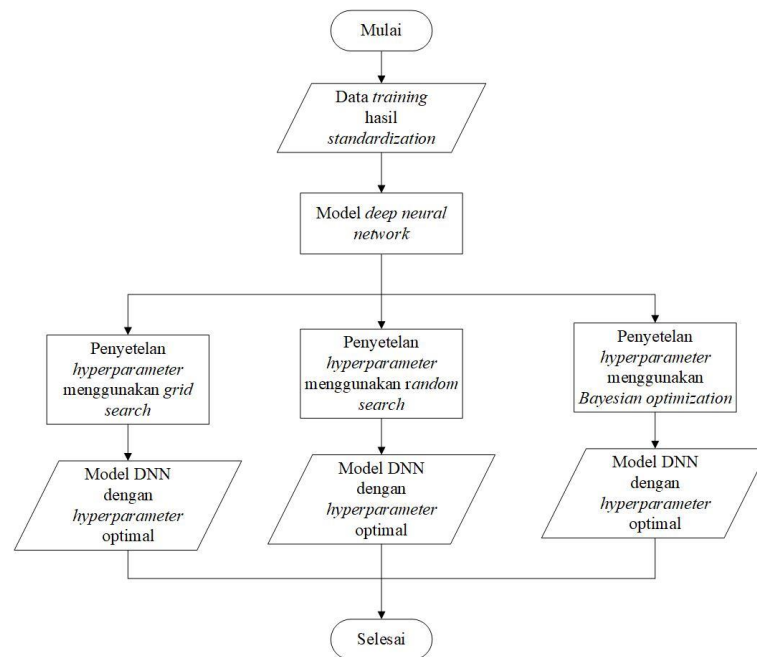
Gambar 3.4 Alur pengembangan DNN dengan penyetelan hyperparameter
