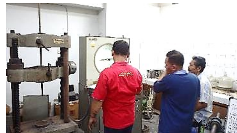
Gambar 7. Pengujian tarik baja tulangan di Laboratorium Struktur dan Bahan Bangunan, Universitas Atma Jaya Yogyakarta
