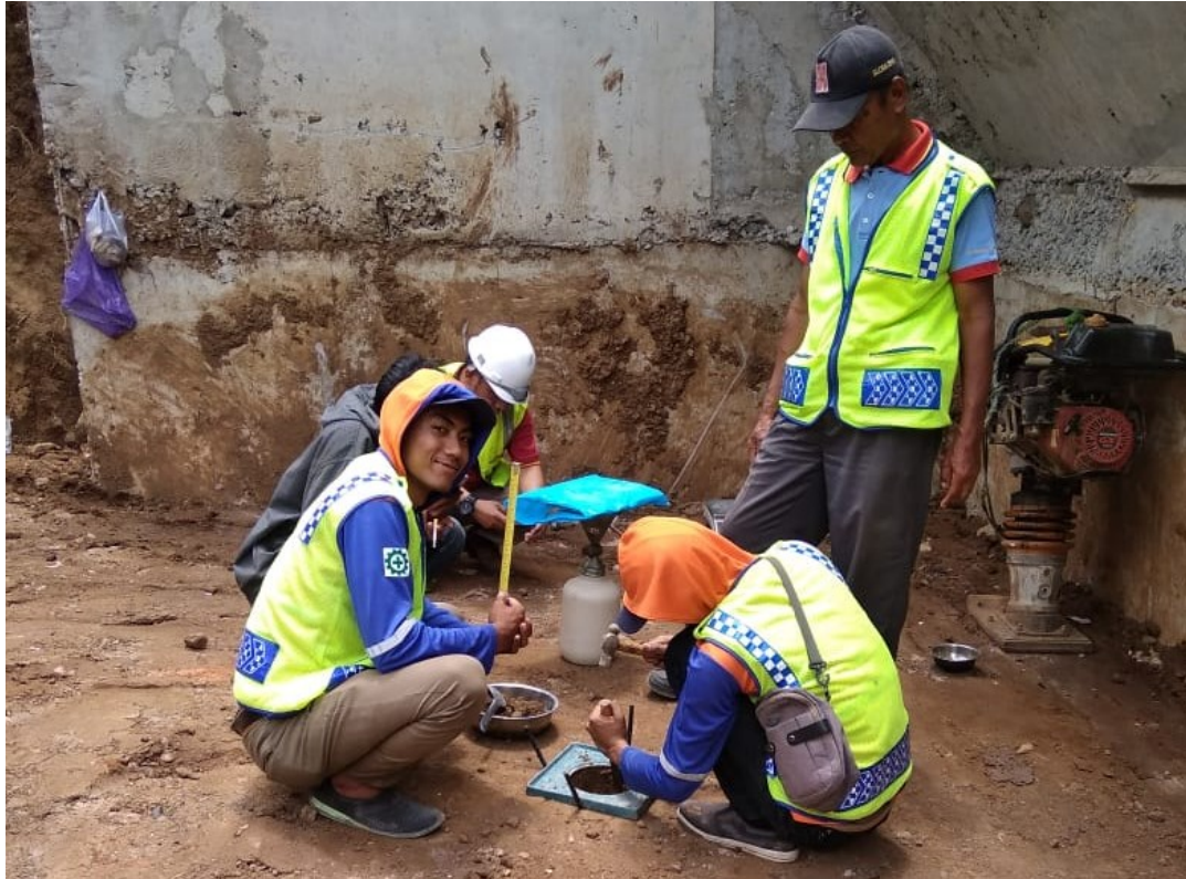
Gambar 3. Pemeriksaan kepadatan tanah di lapangan dengan menggunakan APD
