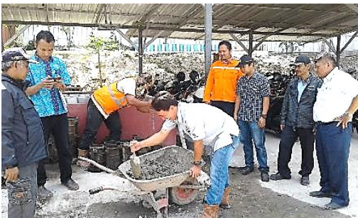
Gambar 8. Kegiatan trial mix campuran beton di batching plant PT Varia, Kab. Magelang
