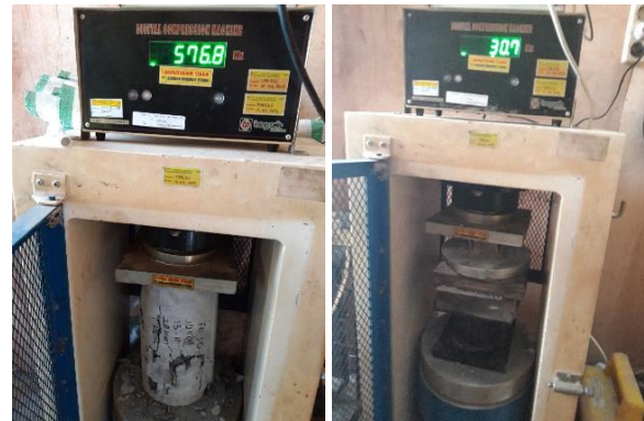
Gambar 13. Pengujian kuat tekan beton dan mortar secara independen di laboratorium penyedia jasa
