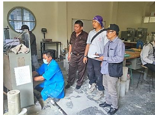
Gambar 11. Pengujian hasil trial mix campuran beton di laboratorium pengujian independen
